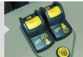
Spínače a tlačítko automatické aktivace na jednotce Command Centre.
