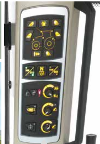
Přepínače otáček vývodového hřídele a ovládače závěsu na sloupku kabiny.
